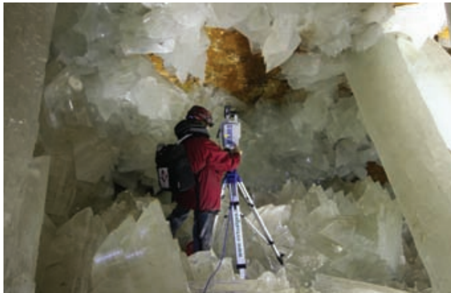
3D laser scanning of the Cueva de los Cristales in Naica (Mexico)
